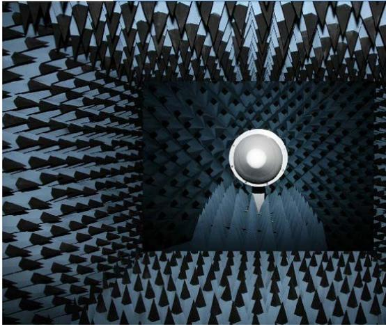
Kammerkalibrierung: In einer Absorberkammer wird die Antenne in verschiedenen Stellungen künstlich erzeugter Satellitensignalen ausgesetzt
