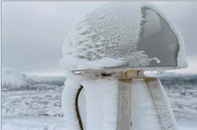
Effekte, die sich auf die GNSS-Messungen auswirken können entweder offensichtlich sein (wie hier im Bild) aber auch aufgrund einer Metallplatte zur Montage der Antenne entstehen.
