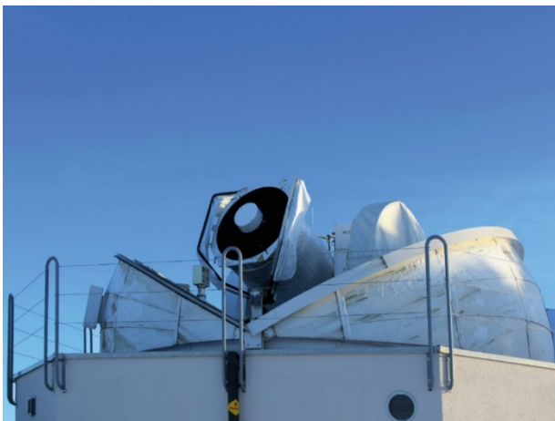
Abb. 1: Das Zimmerwalder Laser- und Astrometrie-Teleskop ZIMLAT, das für die Distanzmessung zu Weltraumschrott-Teilen verwendet wurde.
